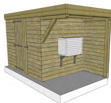
Espace couvert pour pompe à chaleur
