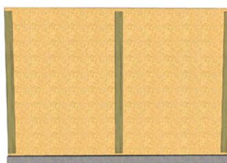
■ BARDAGE OSB INTÉRIEUR
