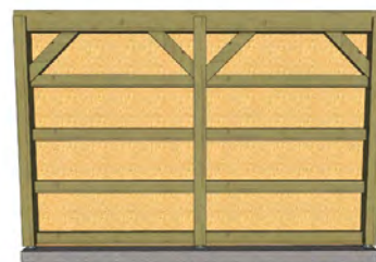
■ BARDAGE OSB EXTERIEUR
